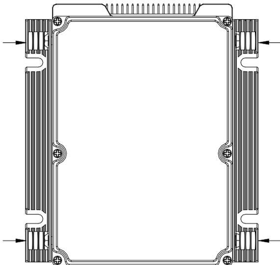
9.1.7 如图：拆卸 PCB 上硬盘安装对应区域的 4PCS M3\*6 十字盘头带弹簧垫圈螺钉，安插好带硬盘架的硬盘，重新锁上 4PCS M3\*6 十字盘头带弹簧垫圈螺钉
