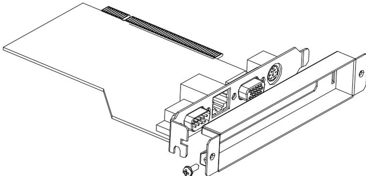
9.2.2 将 PCI 扩展卡插入 PCI 转接卡；用#6-32\*6 十字盘头组合螺钉把 PCI 扩展卡出口端固定与后面板。
