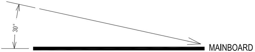
9.1.5 按上图示方法将 miniPCIE 卡插入对应的插槽中,用 1PCS M2\*4 十字槽盘头螺钉将 miniPCIE 卡锁紧。如下图
